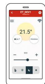
Sur l'écran d'accueil de l'appareil dans l'application mobile, il est possible de sélectionner et de modifier les modes de fonctionnement comme indiqué sur la figure ci-dessus.
